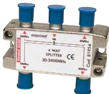
Partitori di segnale Sat+TV, ideali per distribuzioni di segnali analogici e digitali e per impianti centralizzati, si differenziano per il numero di uscite utili. Sono realizzati su meccanica in pressofusione con connettori F. La massima versatilità è garantita dal passaggio di c.c. tra ingresso ed uscite. Frequenza di lavoro: 5÷2400 MHz
