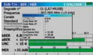
**Visualizza** la presenza ed il relativo livello di un canale analogico "Co-Channel Ind" o di un segnale digitale riflesso "Long Eco Ind" isofrequente al segnale misurato.
