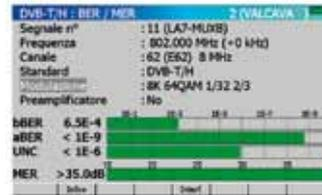
**Frequenza di lavoro** da 45 a 2150 MHz Elevata sensibilità per misure in DVB-T della potenza, del BER e del MER a partire da 35dBµV.
