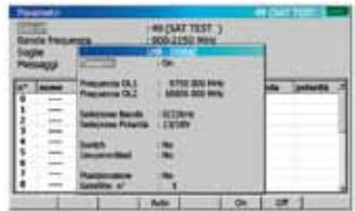
**DISEqC 1.2** per sistemi multiswitch o motorizzati. SatCR per sistemi Unicable fino a 8 porte con ricerca automatica.
