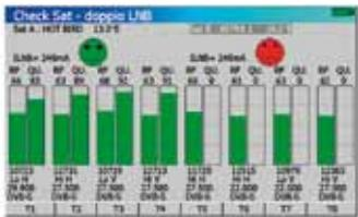
**CHECKSAT:** puntamento rapido della parabola anche con doppio LNB e verifica simultanea fino a 8 polarità.
