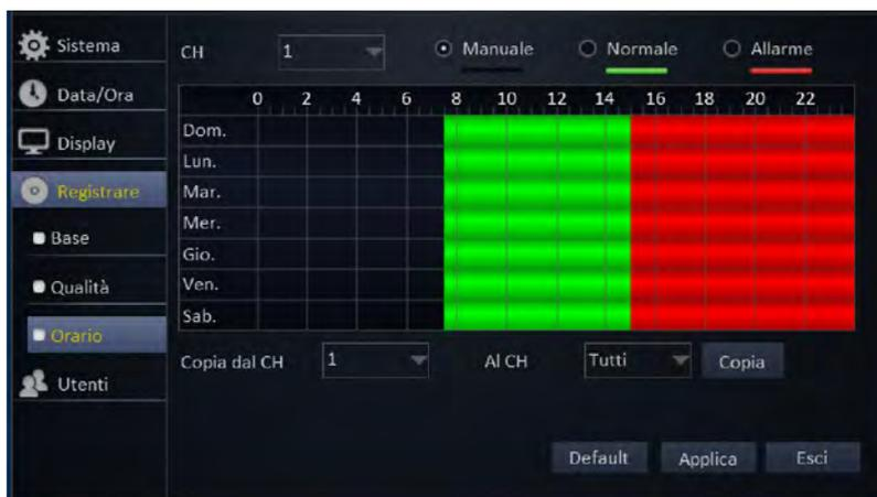
La funzione Orario permette di configurare per ogni telecamera una programmazione schedulata Settimanale/24H.
