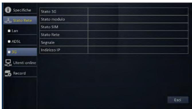
La funzione "3G ", permette di visualizzare le informazioni di collegamento tramite chiavetta 3G.
