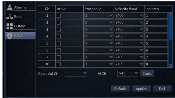
La funzione "PTZ" permette di settare i parametri di comunicazioni RS485 necessari al controllo delle telecamere compatibili collegate al DVR.
