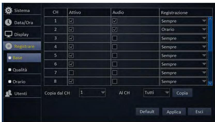
La funzione **Base** permette di selezionare i canali con registrazione attiva e la modalità di programmazione desiderata.
