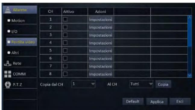
La funzione "Perdita video" permette di selezionare le azioni da eseguire in caso di assenza/perdita del segnale video in ingresso.
