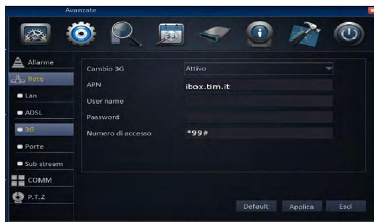
La funzione "3G" permette di configurare i parametri di collegamento tramite chiavetta USB 3G compatibile.
