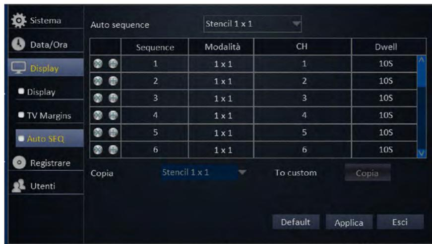
La funzione "Auto Seq" permette di configurare la sequenza delle immagini in modalità di visualizzazione ciclica.
